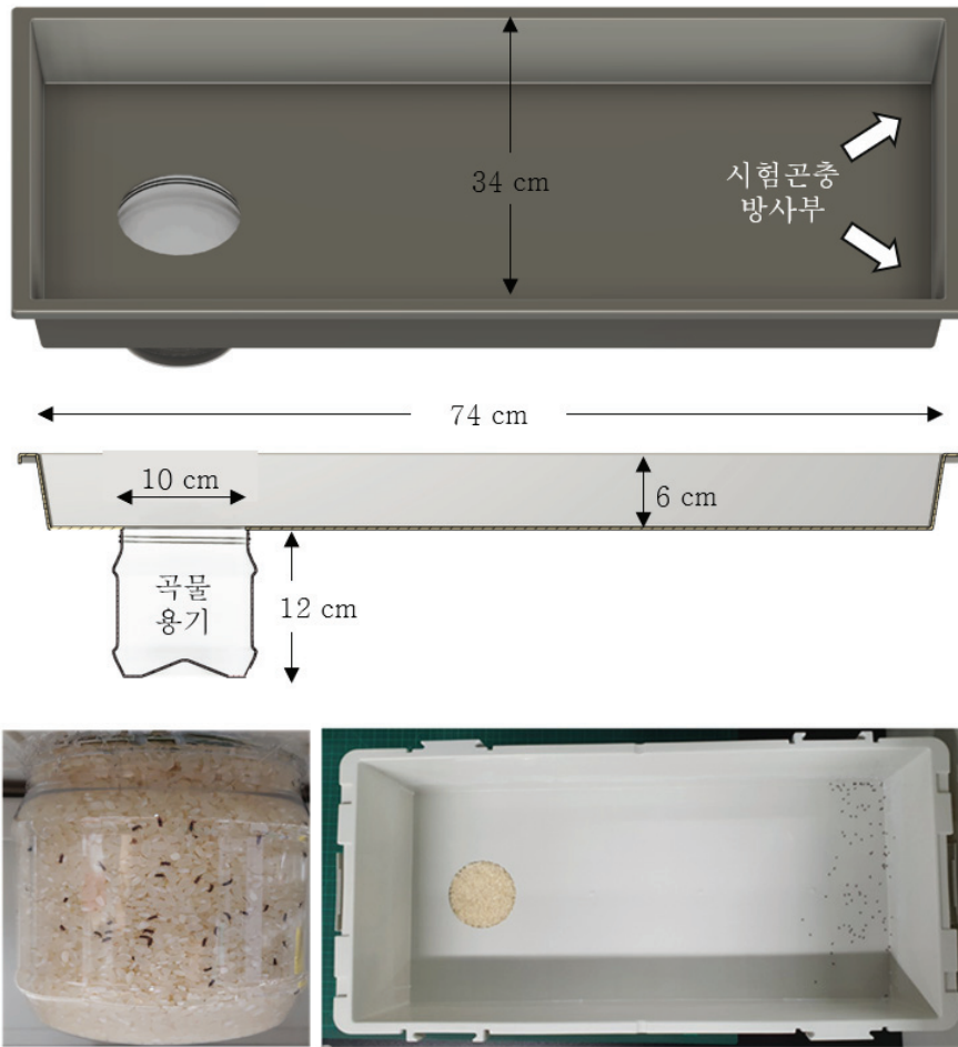
그림 8. 유인억제시험 공간 모식도(상) 및 실제 조립사진(하)
