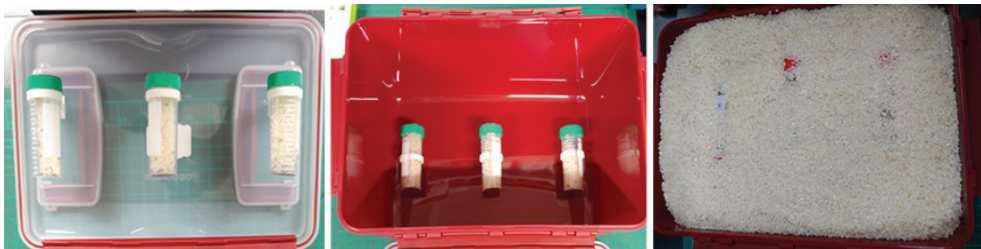
그림 7. 저장물해충의 혼증독성 모의사용시험방법 예시
